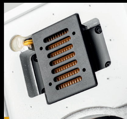
Wysokotonowy AMT zamocowano w dość niekonwencjonalny sposób.
